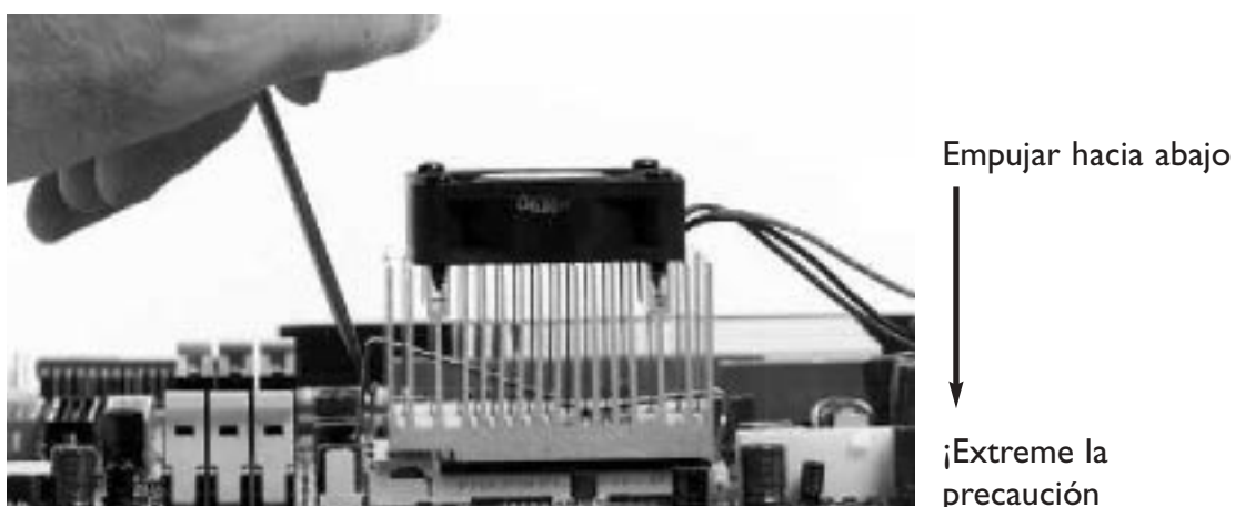
Figura 15. Presionando hacia abajo el clip del disipador de calor.
