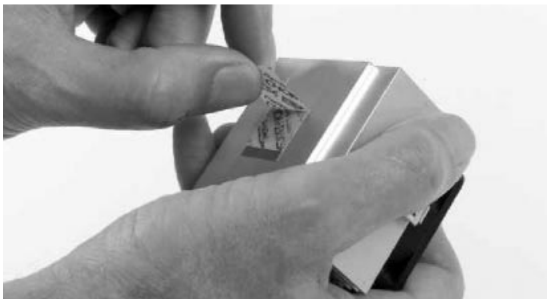
Figura 9. Retire la película de plástico del material térmico con un movimiento rápido.
